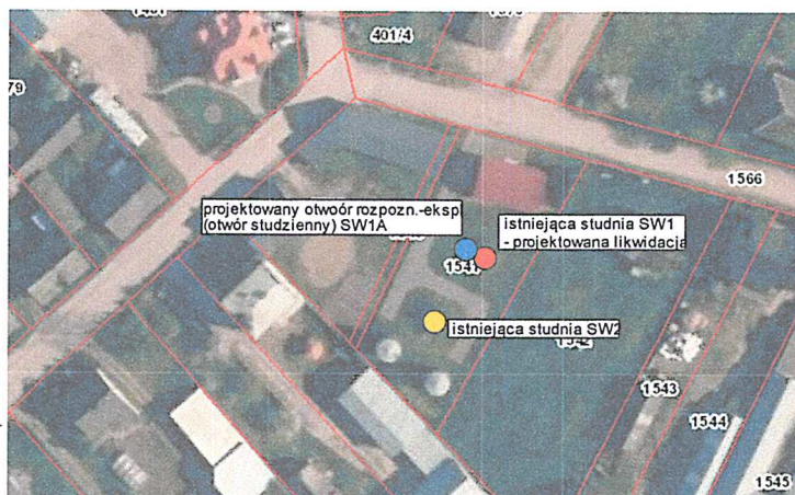
Rys. 1. Położenie projektowanej studni do likwidacji SW1 – zdjęcie satelitarne (źródło: www.geoportal.gov.pl )
